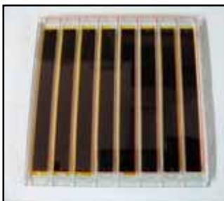
CNT 染料感應太陽電池のモジュール
